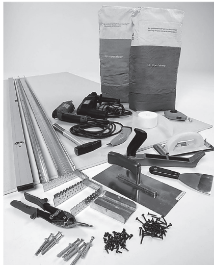
Fig. 8. Unelte utilizate pentru montarea sistemului de gips-carton
